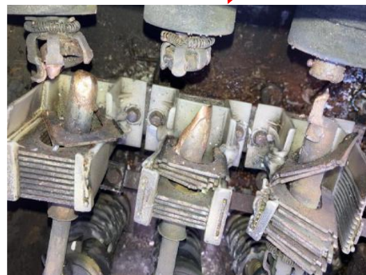
③一次側固定接触部の破損状態
