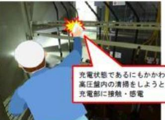
【図2】受電室の感電死傷事故のイメージ
