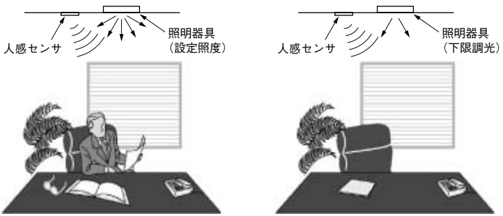
図-3 不在時消灯・下限調光制御
