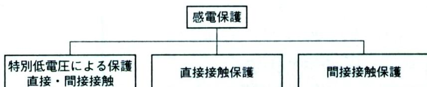
図一 2 IEC 規格における感電保護の体系
