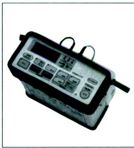
[図-6] 全天候型配電用万能測定器
