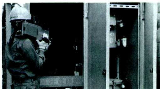
[図-2] ポータブル式熱画像装置
