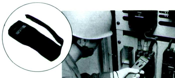
[図-1] 放射温度計(簡易形)による測定
